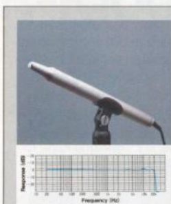
MU-M9 Meß-Mikrofon (im Beipack) zur Kompensation der Raumakustik.
